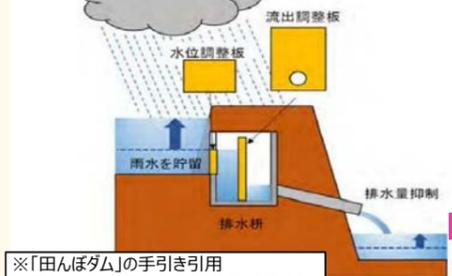
取組5 雨水貯留・浸透施設の設置【町,県】 新規着手
